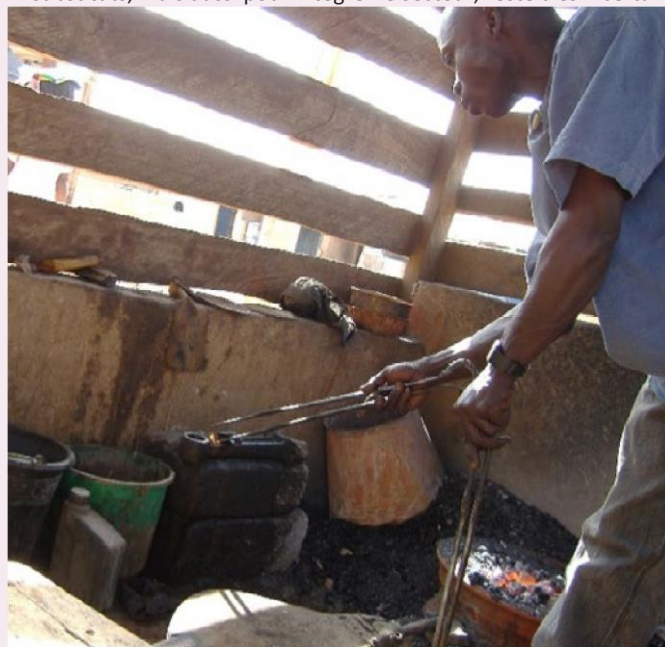
Planche 1 : Des mineurs brûlant de l'amalgame de mercure sans équipement de protection est une vue courante.
